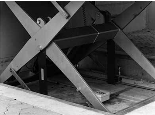
Bild 9: Bei ausgefahrenen Stützen ist das Instandhaltungspersonal gegen ein unbeabsichtigtes Absenken der Hebebühne geschützt.
