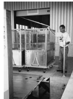
Bild 3: Dieser Bediener hat für das Heben und Absenken der Hebebühne eine gute Sicht.
